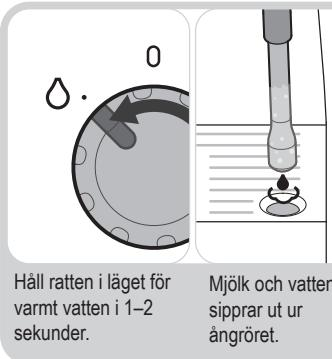
Håll ratten i läget för varmt vatten i 1–2 sekunder.
