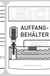
Abtropfschale entfernen und Auffangbehälter herausnehmen.
